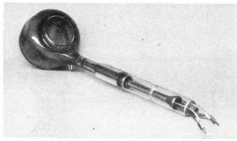
Bild 4. Fernseh-Projektionsröhre für Großbildempfang
