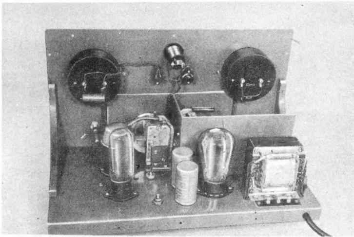
Bild 5. Rückansicht mit Netzteil im Vordergrund
